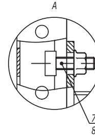
1. После проведения сварочных работ необходимо произвести антикоррозионную обработку крепления BSW-41 поз. 2 и сварного шва цинковой спрей-краской 37039HDZ.
