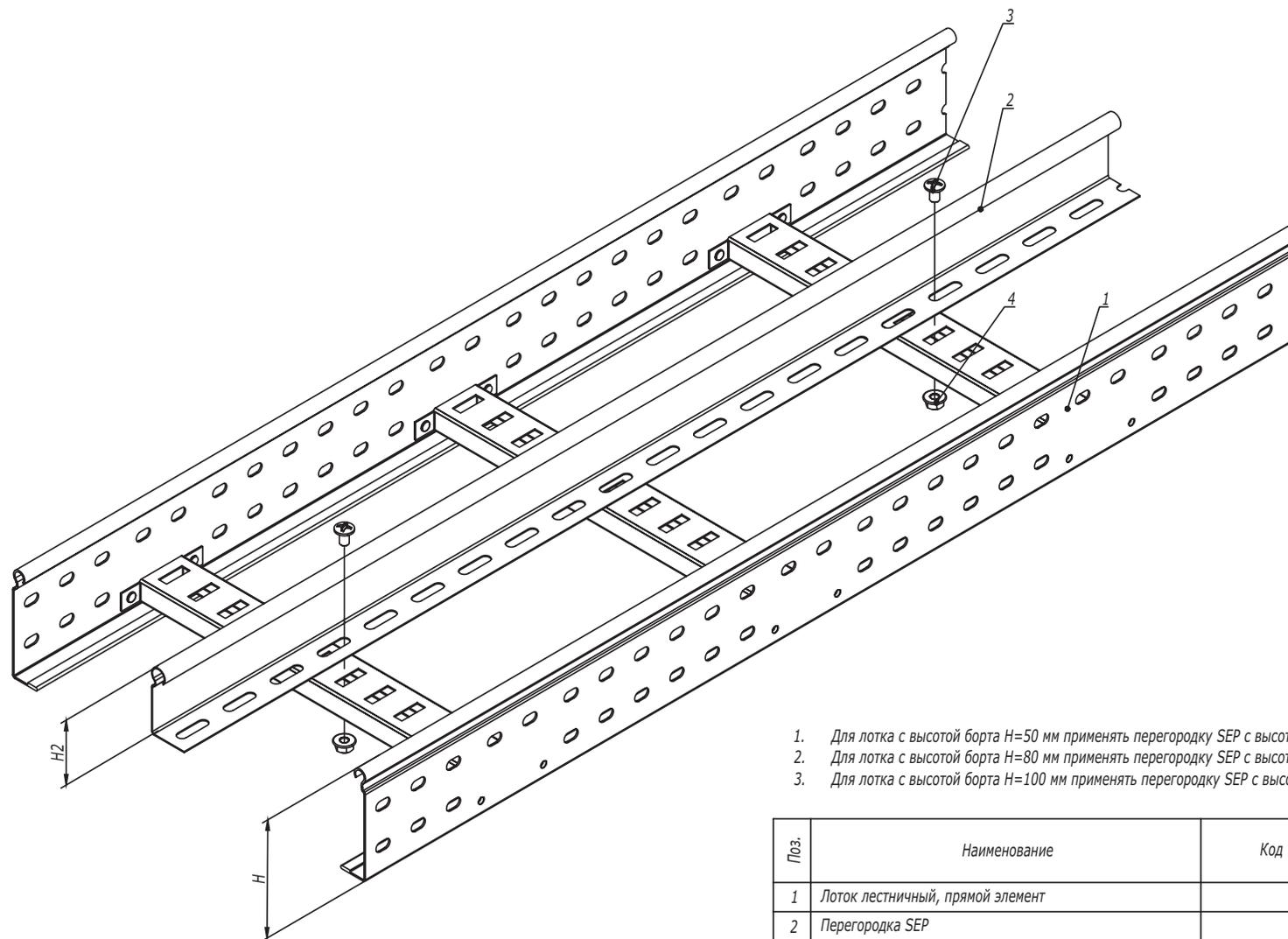
1. Для лотка с высотой борта  $H=50$  мм применять перегородку SEP с высотой  $H2=30$  мм.
