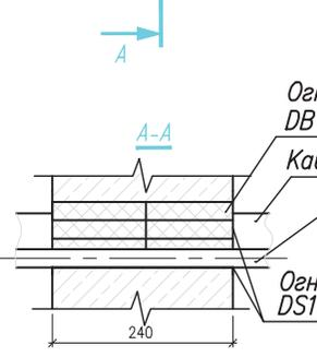
Все получившиеся в ходе монтажа проходки щели и стыки необходимо заполнить огнестойким герметиком.
