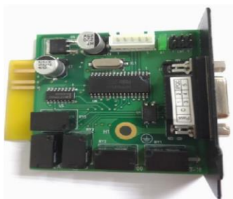
Рисунок 10 – Внешний вид платы AS400
