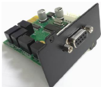
Рисунок 10 – Внешний вид платы AS400
