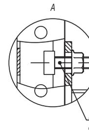
1. После проведения сварочных работ необходимо произвести антикоррозионную обработку крепления BSW-41 поз. 2 и сварного шва цинковой спрей-краской 37039HDZ.
