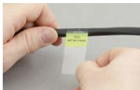
Закрепить маркировочный элемент на поверхности
