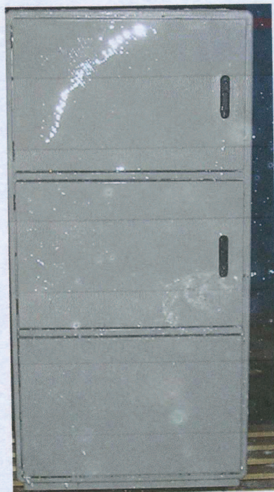
Рис. 5 Корпус шкафа из фибергласа «Conchiglia» в процессе обрызгивания оболочки со всех сторон водой.
