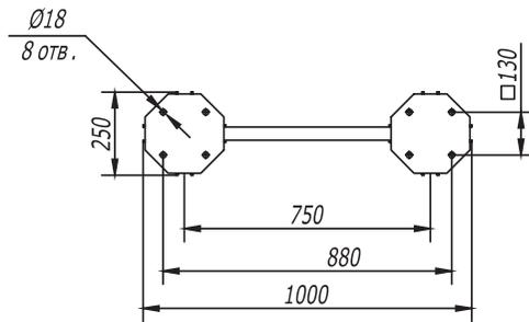
1. Момент затяжки болтов и гаек М12 — 90-100 Нм.
