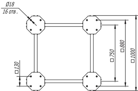
1. Момент затяжки болтов и гаек М 12 – 90-100 Нм.
