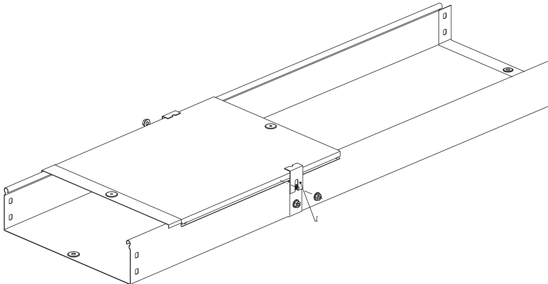
1. Установить держатель на стыке лотков, зафиксировав гайкой.
