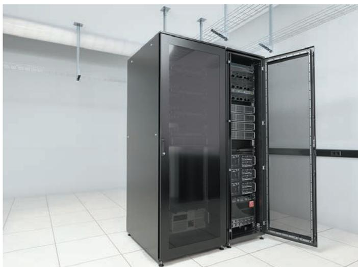
19-дюймовые коммутационные шкафы ДКС шириной 800 мм и высотой от 24 до 47 юнитов разработаны для размещения активного сетевого оборудования и коммутационных панелей. Свободное пространство сбоку от 19-дюймовой рамы шкафа позволяет организовать вертикальные кабельные трассы для размещения коммутационных шнуров, в том числе предназначенных для межстоечной коммутации в зонах HDA.
