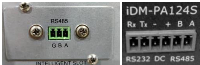
Рисунок 22 – Установка RS485
