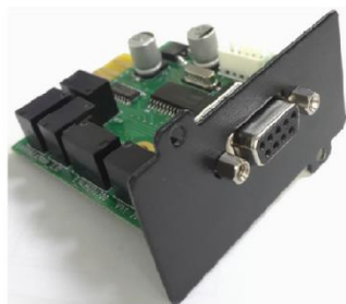
Рисунок 20 – Внешний вид платы AS400
