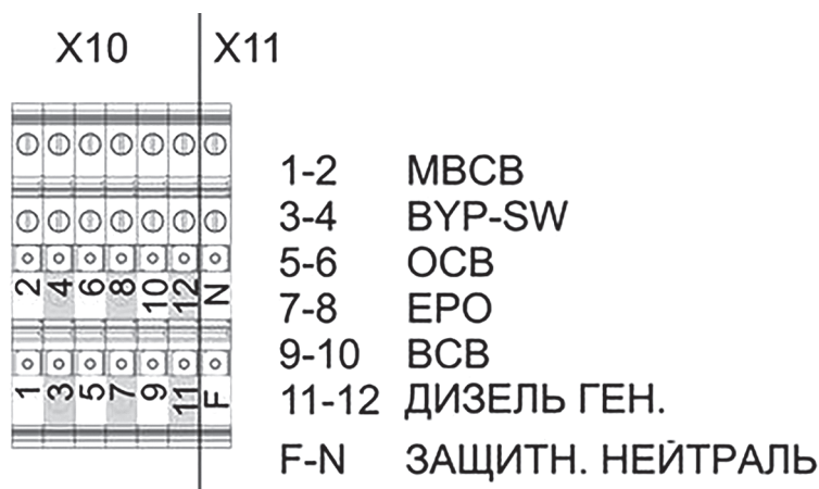
Рисунок 17 – Дополнительные клеммы EXTRA ТТ 60+160 кВА
