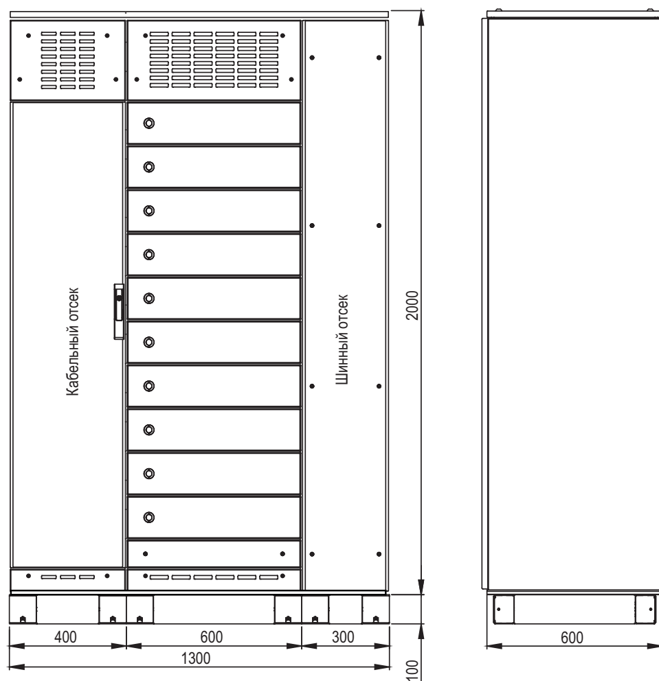
Габаритные размеры шкафа (масса шкафа не более 400 кг). Секционные двери показаны условно
